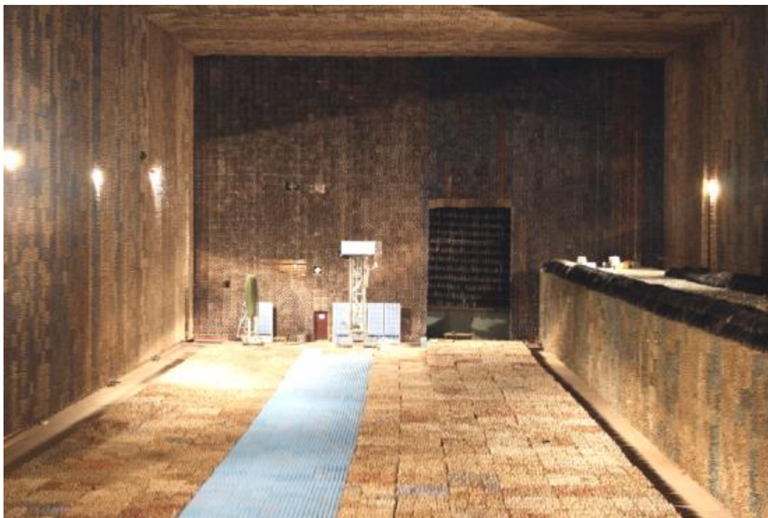
Общий вид большой безэховой камеры
