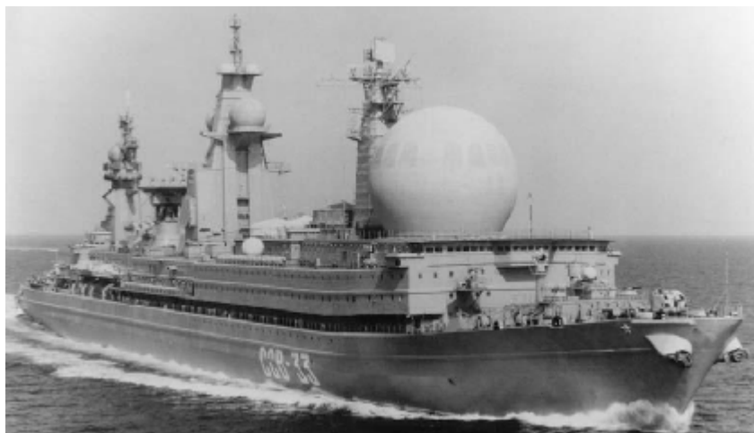
Корабль ССВ-33 «Урал» с радиотехническим комплексом «Коралл». В носовой части – купол РЛС «Атолл»
