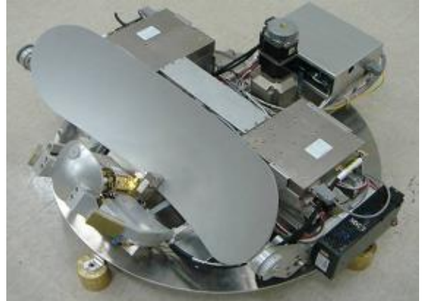
Рис. 17. Низкопрофильная двухзеркальная следящая антенна с профилированными зеркалами для многодиапазонной мобильной спутниковой связи на транспорте [75].
