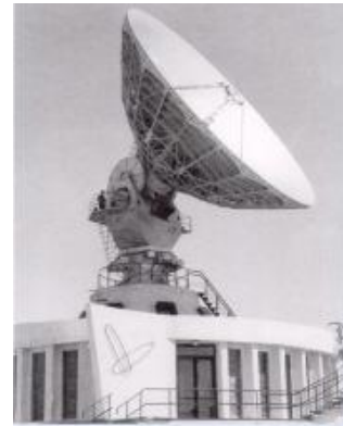
Рис. 8. Антенна ТНА-57 земной станции системы спутниковой связи «Орбита» (п. Медвежьи Озера) [9].
