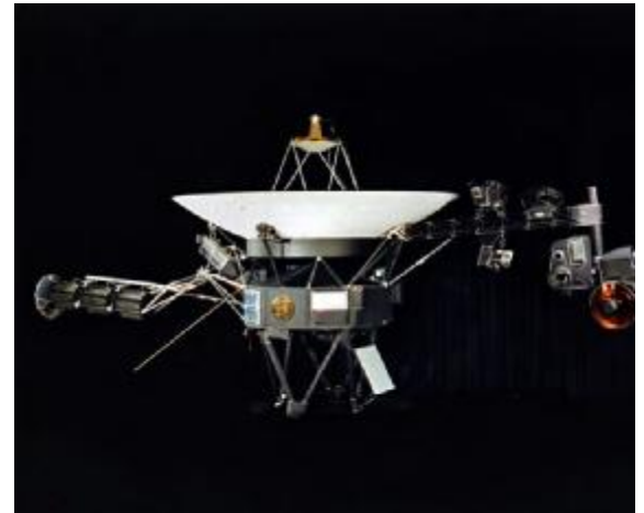
Рис. 12. Спутник Voyager с двухзеркальной антенной для передачи данных на Землю [42].
