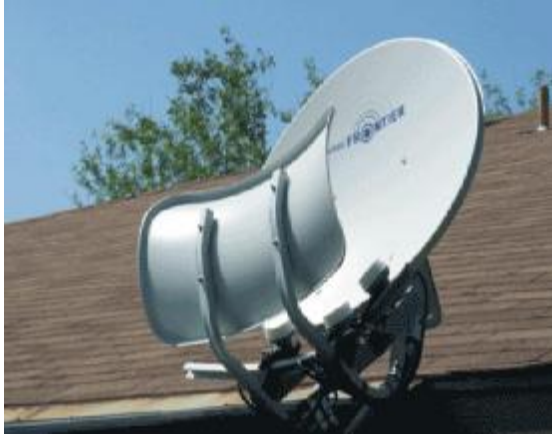
Рис. 16 Многолучевая двухзеркальная антенна для связи с несколькими геостационарными спутниками [69, 70].
